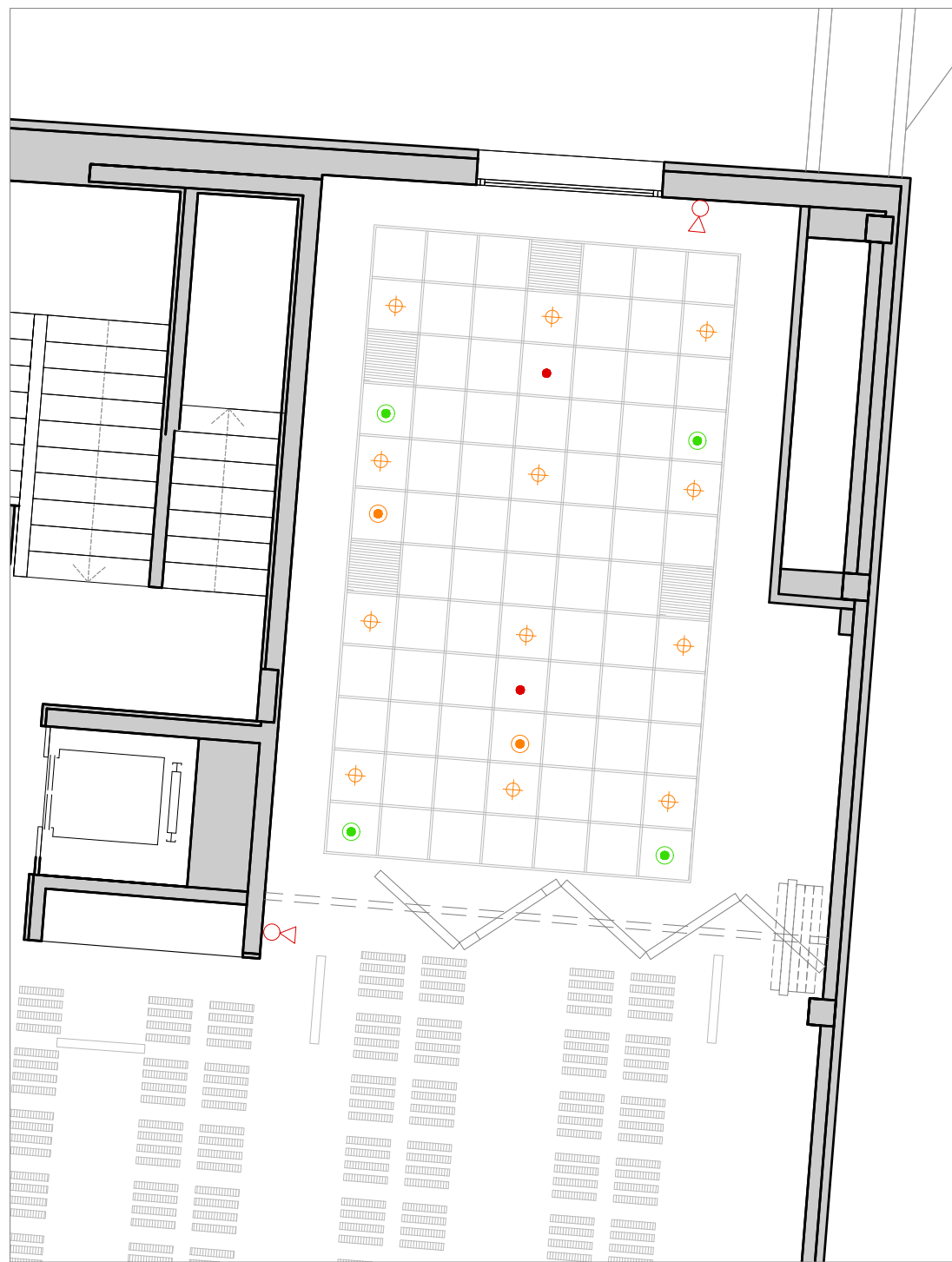
INSTAL·LACIÓ D'IL·LUMINACIÓ I CONTRA INCENDIS E 1/75
