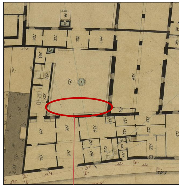
Detalls del creixement de la crugia posterior de l'edifici mitjançant una nova façana en vidre. Font: AMDCV
