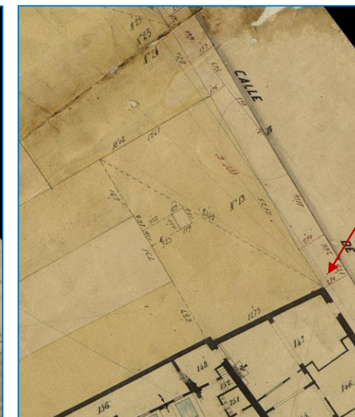
Detall amb indicació de la zona de contacte d'ambdues façanes. Notem l'absència de cap tipus d'angle entre els dos fronts construïts
