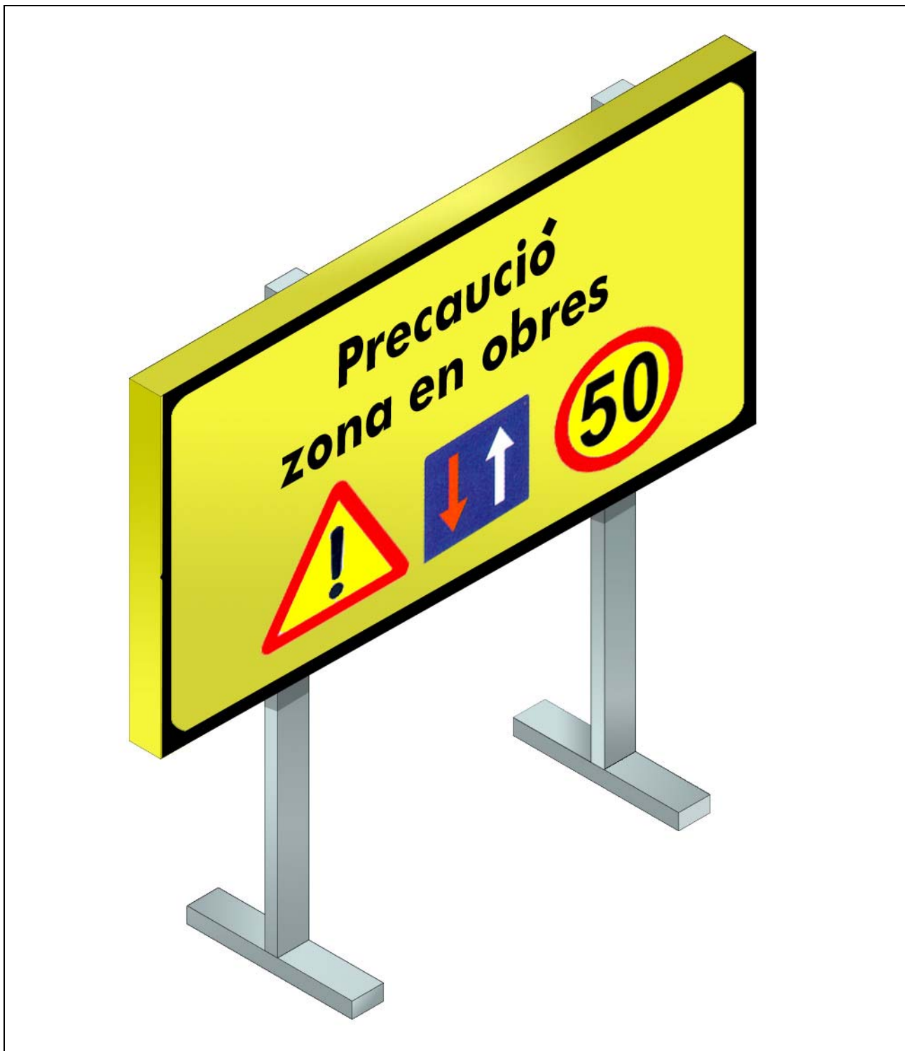
Senyalització obres: Precaució, zona en obres
