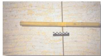
Figura 22. Disposición de pasadores previamente al hormigonado o insertados durante el mismo.
