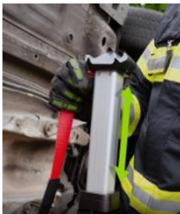
Fig 2. Extensió i recollida amb bloqueig automàtic
