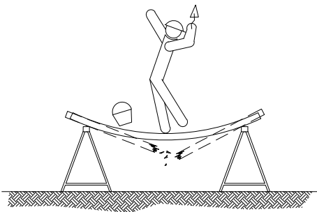
SI LA DISTÀNCIA ENTRE BORRIQUETES ÉS MAJOR DE 3 METRES, EXISTEIX EL PERILL QUE LES FUSTES DE LA PLATAFORMA PUGUIN FLETXAR O FINS I TOT ARRIBAR A TRENCAR-SE
