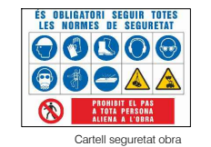
Cartell seguretat obra
