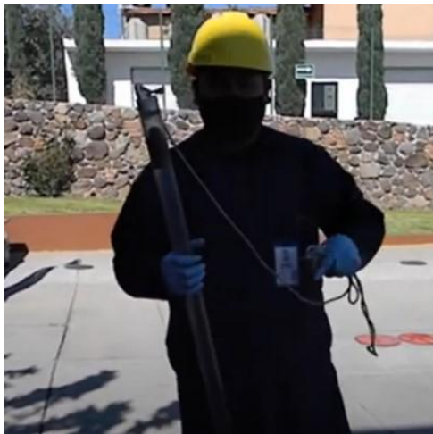
Dispositiu Bailer de recollida de mostres en piezòmetres
