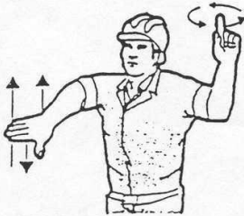
10 Bajar el aguilón o pluma y levantar la carga
