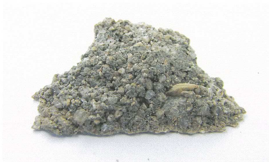
Fotografia de la mostra extreta del sondatge 16. Es pot apreciar la granulometria de l'àrid del morter MTM. També podem veure a la part dreta de la fotografia una impuresa vegetal
