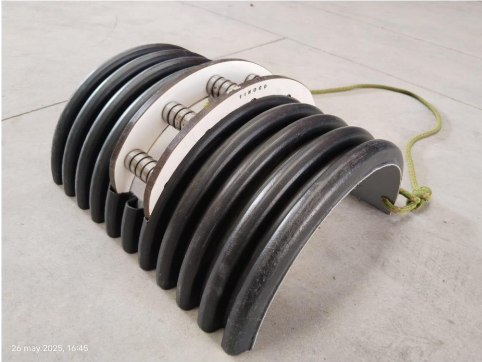
7) Protector rígid i compacte amb rodaments per cordes en moviment
