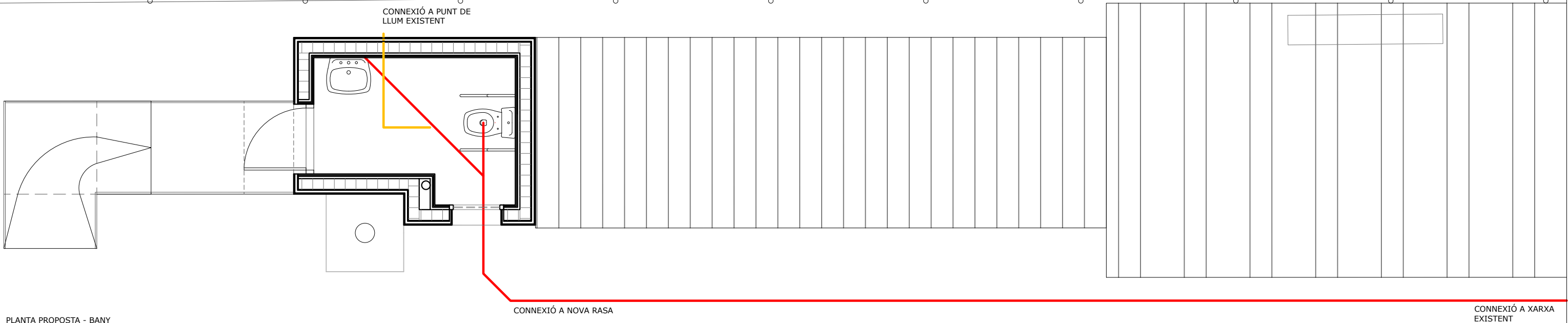
PLANTA PROPOSTA - BANY CONNEIXIÓ A NOVA RASA CONNEIXIÓ A XARXA EXISTENT
