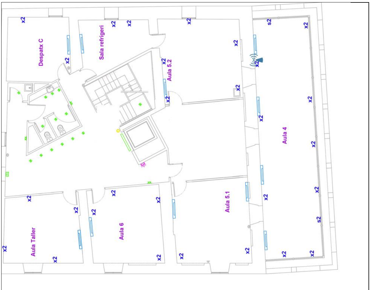
Distribució punts de connexió planta primera
