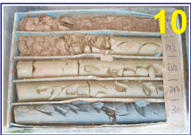
Muestras del sondeo PZ-71. Caja 10. Profundidad de 27.00 a 30.00 m.
