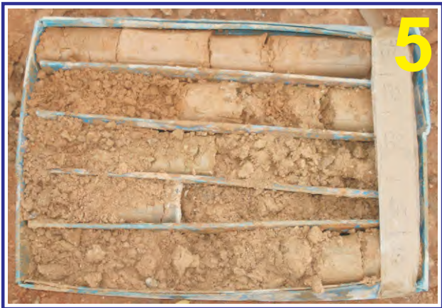
Muestras del sondeo PZ-6l. Caja 5. Profundidad de 12.00 a 15.00 m.
