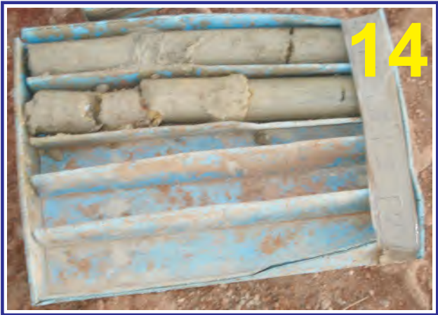
Muestras del sondeo PZ-6l. Caja 14. Profundidad de 39.00 a 40.20 m.
