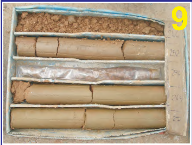
Muestras del sondeo PZ-2I. Caja 9. Profundidad de 24.00 a 27.00 m.
