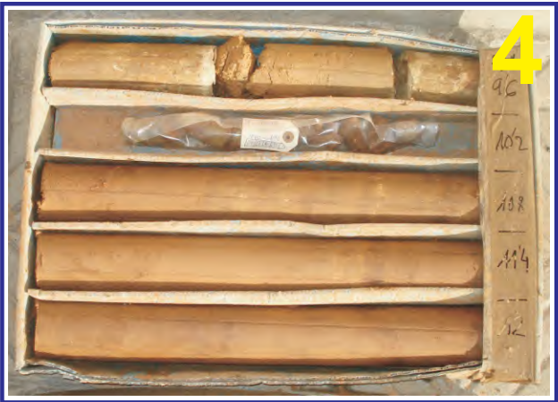
Muestras del sondeo PZ-7I. Caja 4. Profundidad de 9.00 a 12.00 m.
