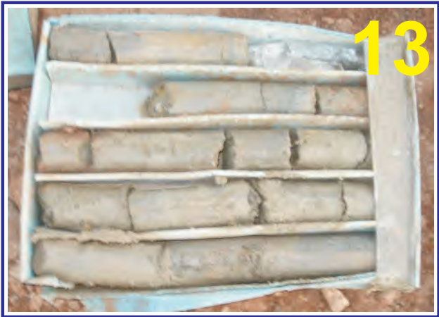
Muestras del sondeo PZ-6l. Caja 13. Profundidad de 36.00 a 39.00 m.
