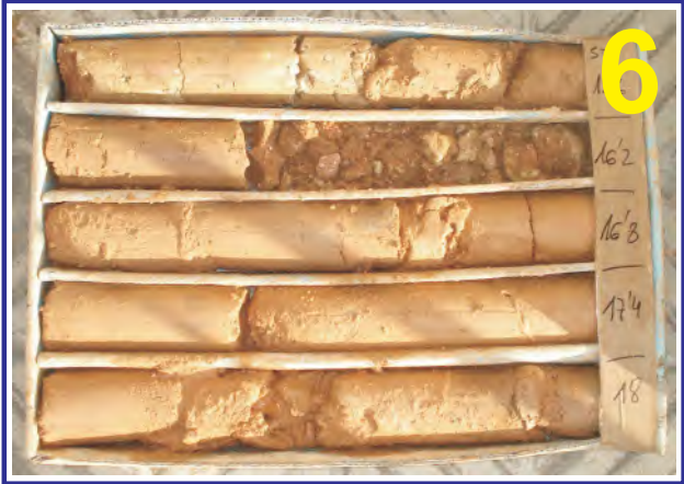
Muestras del sondeo PZ-71. Caja 6. Profundidad de 15.00 a 18.00 m.
