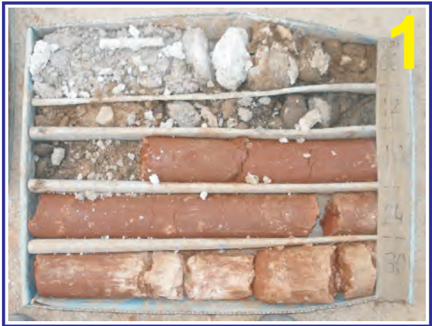
Muestras del sondeo PZ-2I. Caja 1. Profundidad de 0.00 a 3.00 m.
