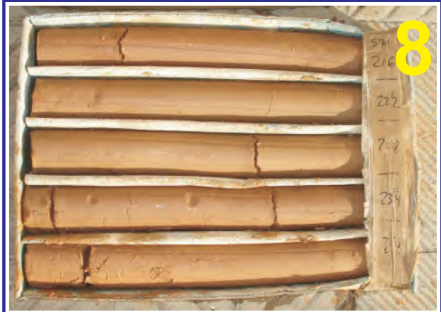
Muestras del sondeo PZ-71. Caja 8. Profundidad de 21.00 a 24.00 m.
