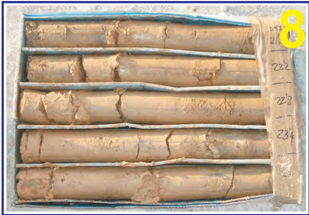
Muestras del sondeo PZ-9I. Caja 8. Profundidad de 21.00 a 24.00 m.
