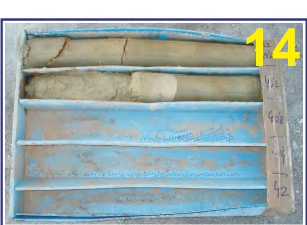
Muestras del sondeo PZ-9I. Caja 14. Profundidad de 39.00 a 40.00 m.
