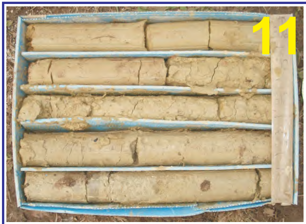
Muestras del sondeo PZ-5D. Caja 11. Profundidad de 30.00 a 33.00 m.
