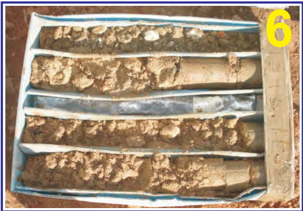
Muestras del sondeo PZ-6l. Caja 6. Profundidad de 15.00 a 18.00 m.
