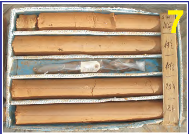
Muestras del sondeo PZ-71. Caja 7. Profundidad de 18.00 a 21.00 m.
