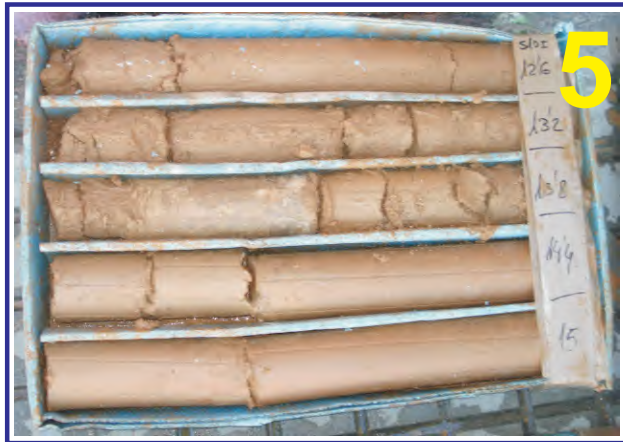
Muestras del sondeo PZ-10I. Caja 5. Profundidad de 12.00 a 15.00 m.
