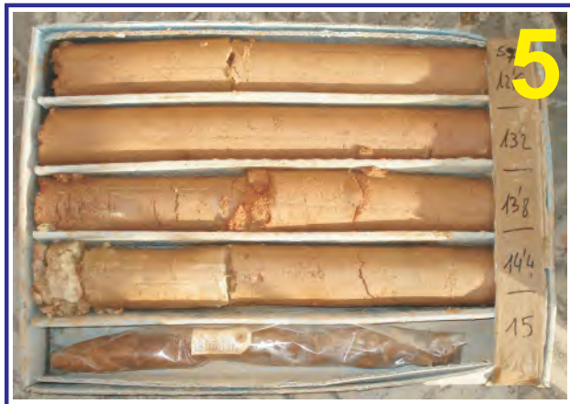
Muestras del sondeo PZ-71. Caja 5. Profundidad de 12.00 a 15.00 m.
