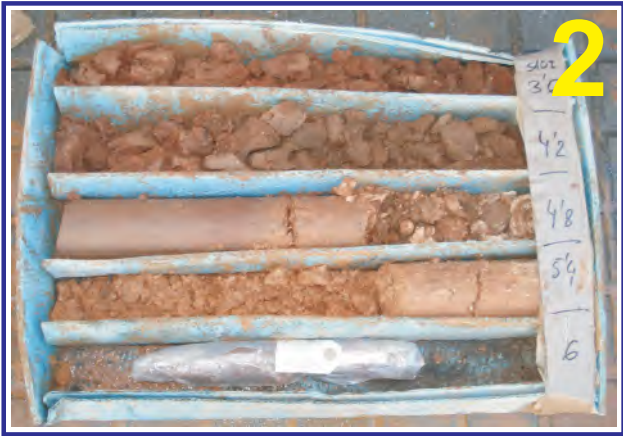
Muestras del sondeo PZ-10I. Caja 2. Profundidad de 3.00 a 6.00 m.
