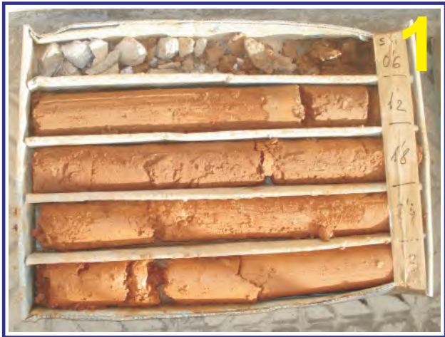
Muestras del sondeo PZ-7I. Caja 1. Profundidad de 0.00 a 3.00 m.
