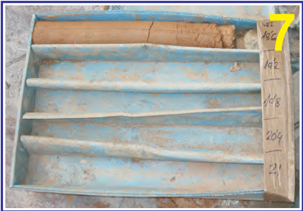
Muestras del sondeo PZ-8I. Caja 7. Profundidad de 18.00 a 18.60 m.
