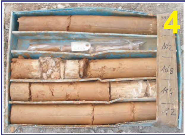
Muestras del sondeo PZ-9I. Caja 4. Profundidad de 9.00 a 12.00 m.
