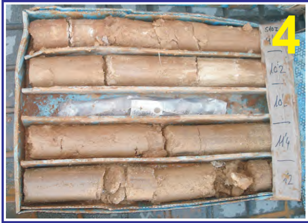
Muestras del sondeo PZ-10I. Caja 4. Profundidad de 9.00 a 12.00 m.
