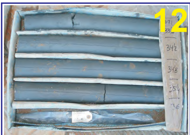
Muestras del sondeo PZ-71. Caja 12. Profundidad de 33.00 a 36.00 m.
