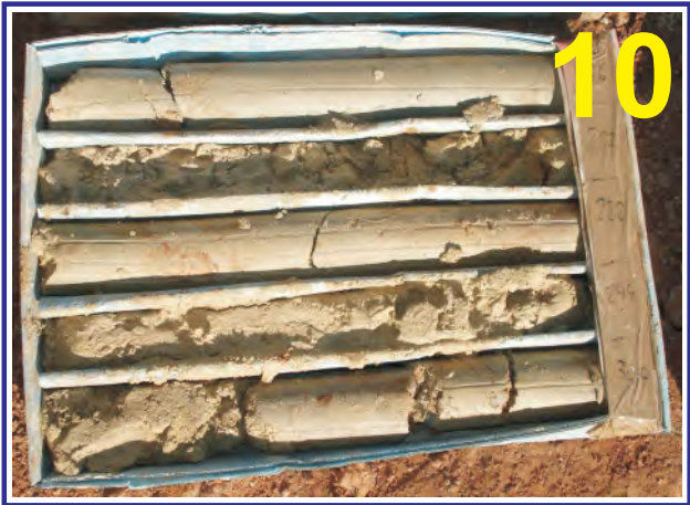
Muestras del sondeo PZ-6l. Caja 10. Profundidad de 27.00 a 30.00 m.
