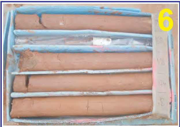
Muestras del sondeo PZ-3I. Caja 6. Profundidad de 15.00 a 18.00 m.
