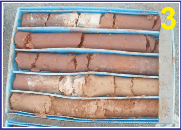
Muestras del sondeo PZ-3I. Caja 3. Profundidad de 6.00 a 9.00 m.
