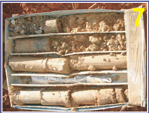
Muestras del sondeo PZ-6l. Caja 7. Profundidad de 18.00 a 21.00 m.
