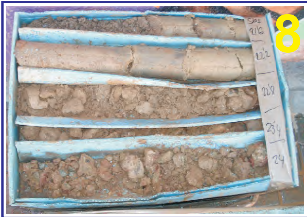
Muestras del sondeo PZ-10I. Caja 8. Profundidad de 21.00 a 24.00 m.
