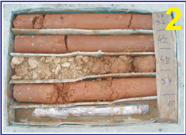
Muestras del sondeo PZ-8I. Caja 2. Profundidad de 3.00 a 6.00 m.
