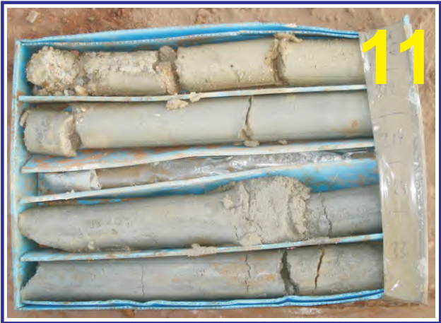
Muestras del sondeo PZ-6l. Caja 11. Profundidad de 30.00 a 33.00 m.
