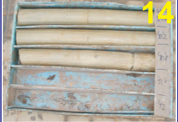
Muestras del sondeo PZ-10I. Caja 14. Profundidad de 39.00 a 40.00 m.
