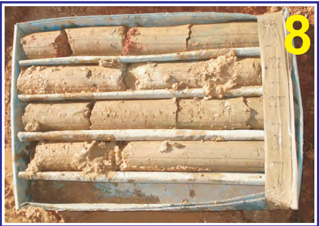
Muestras del sondeo PZ-6l. Caja 8. Profundidad de 21.00 a 24.00 m.
