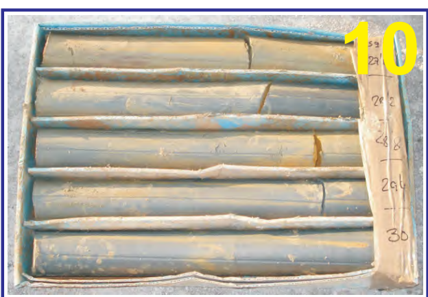
Muestras del sondeo PZ-9I. Caja 10. Profundidad de 27.00 a 30.00 m.
