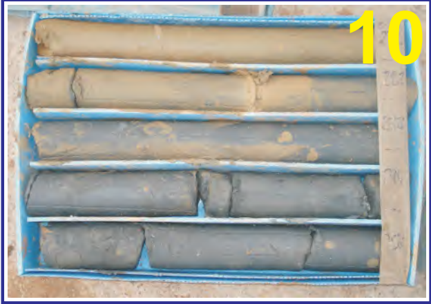
Muestras del sondeo PZ-2I. Caja 10. Profundidad de 27.00 a 30.00 m.
