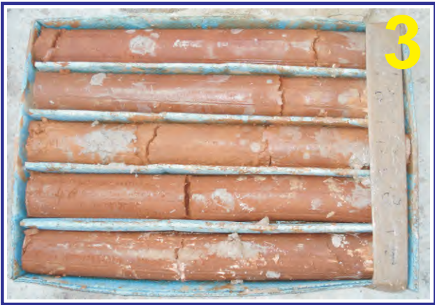
Muestras del sondeo PZ-8I. Caja 3. Profundidad de 6.00 a 9.00 m.
