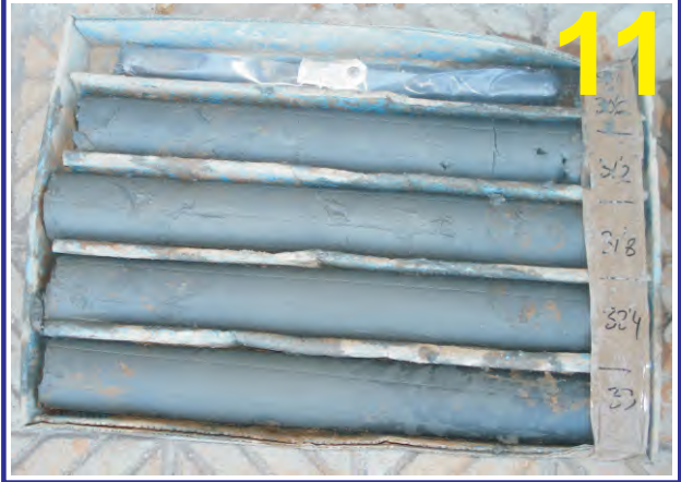
Muestras del sondeo PZ-71. Caja 11. Profundidad de 30.00 a 33.00 m.
