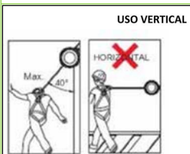
Figura 7. Ejemplo posicionamiento incorrecto dispositivo retráctil
