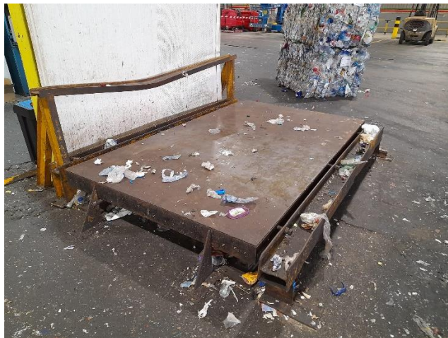
Báscula fija a integrar en el nuevo sistema de control
