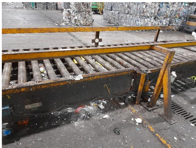
Ejemplo de cinta de rodets con protecciones laterales
