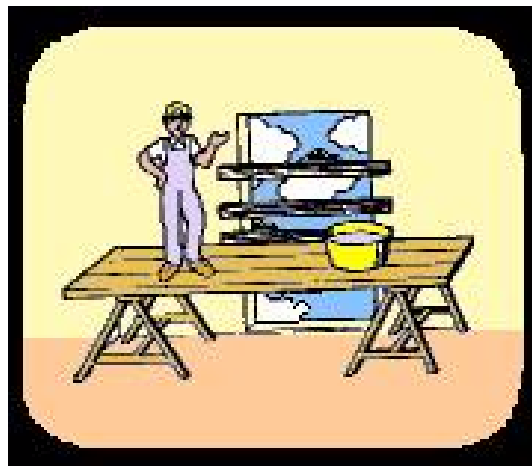
En treballs en interiors a prop d'obertures en les parets de tancament, es podrà protegir aquestes obertures mitjançant una sèrie de taulons disposats horitzontalment.
