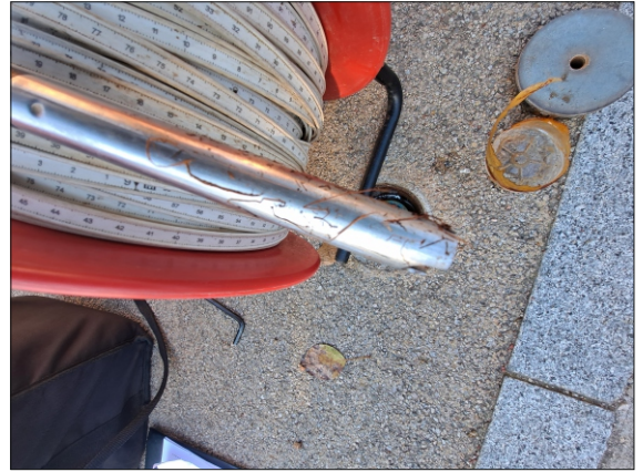
Detalle de la sonda después de medir al P2. Observar la presencia de restos vegetales
