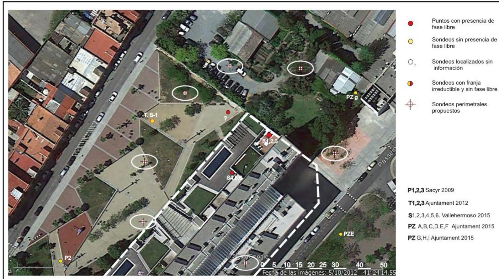
Figura 5. Sondeos de investigación disponibles y propuesta de 7 sondeos perimetrales
