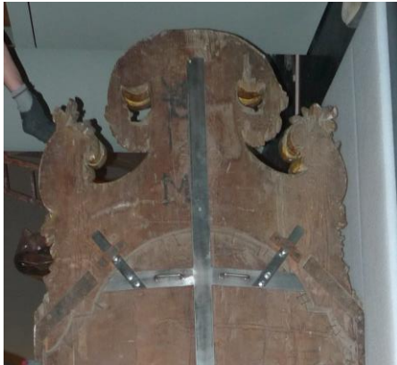
Detall del sistema de subjecció adaptat a la peça, part superior e inferior
