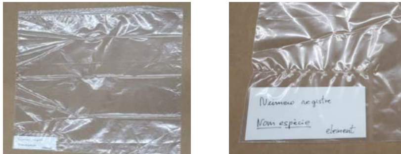
Fotografia 2. A la imatge de l'esquerra es mostra la bossa de polietilè amb tancament Zip i la disposició de l'etiqueta a la part més llunyana de l'obertura. A la imatge de la dreta es mostra el detall del termosegellat que aïlla l'etiqueta de l'element preparat
