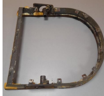
Estructura interior metàl·lica seient
