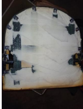
Exemple de l'estat actual de les tires elàstiques a l'interior del seient
