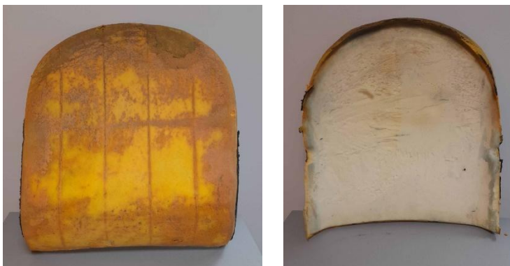
Exemple de l'estat actual de l'escuma a retirar
